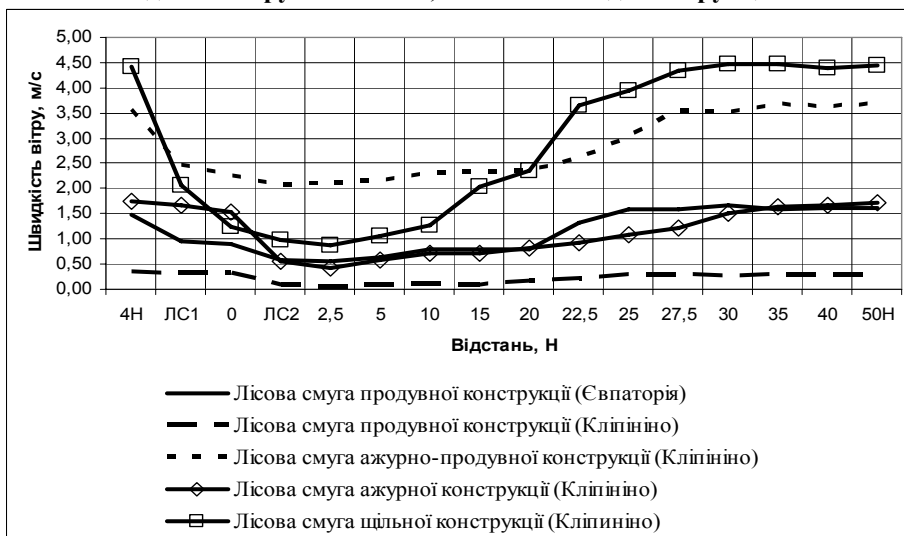
Рис. 5 – Швидкість вітру на висоті 0,3 м залежно від конструкції лісових смуг
